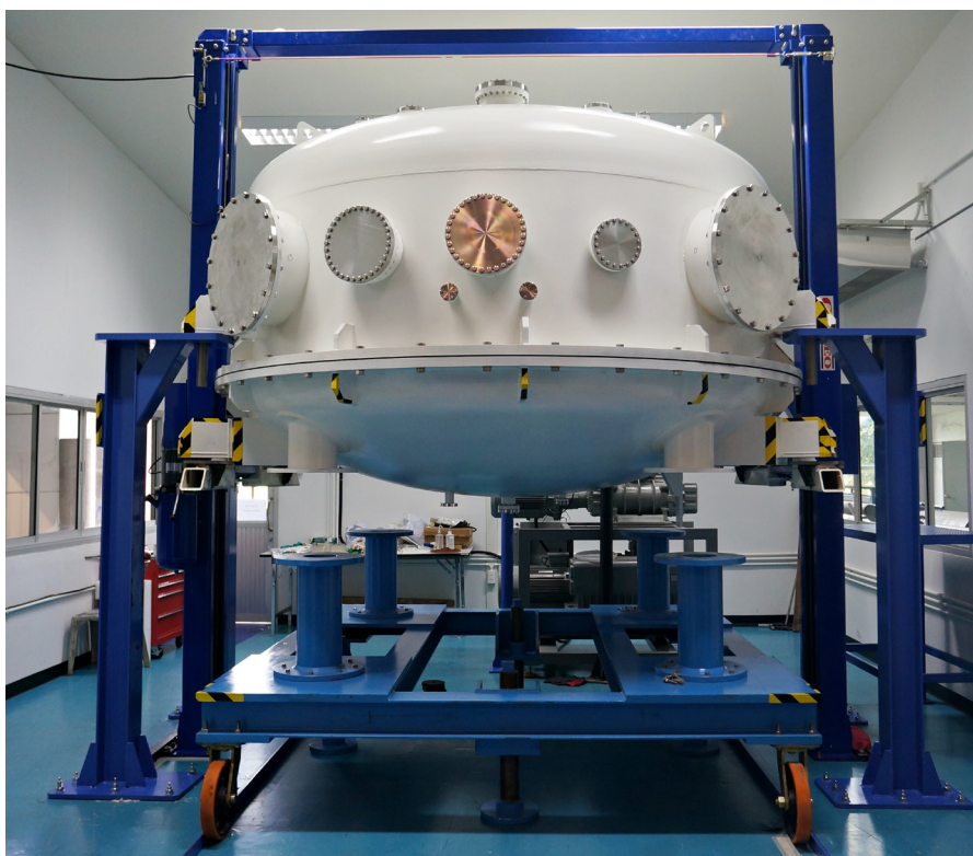
ภาพที่ 4 ภาพแสดงรูปร่างของระบบเคลือบกระจกที่สร้างและพัฒนาขึ้นสำหรับหอดูดาวแห่งชาติ เจลิมพระเกียรติ (ออกแบบระบบโดย สช.)
