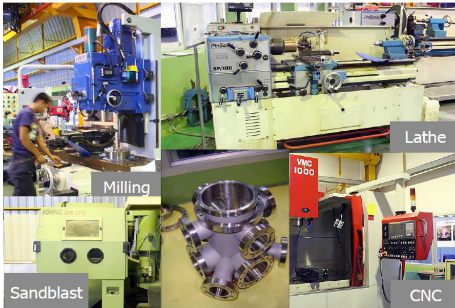
รูปที่ 3 ตัวอย่างเครื่องจักร และชิ้นงานสุญญากาศที่ผลิตโดยโรงเครื่องมือกลของ สช.
